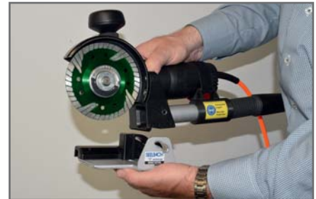
Zum freihändigen Schneiden kann der Führungsschuh einfach demontiert werden.
